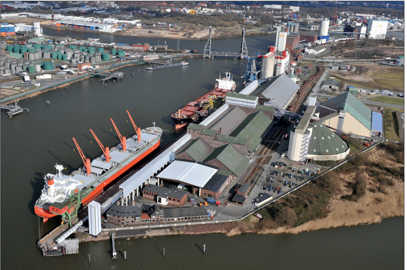
Bild 2: 4,3 km Gleisanlagen, Platz für bis zu drei große Schiffe und eine Wassertiefe von 11,3 m: Der Kali-Kai in Hamburg
